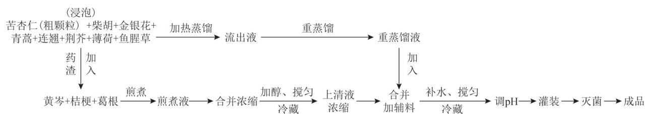
图1 柴银口服液生产工艺流程
